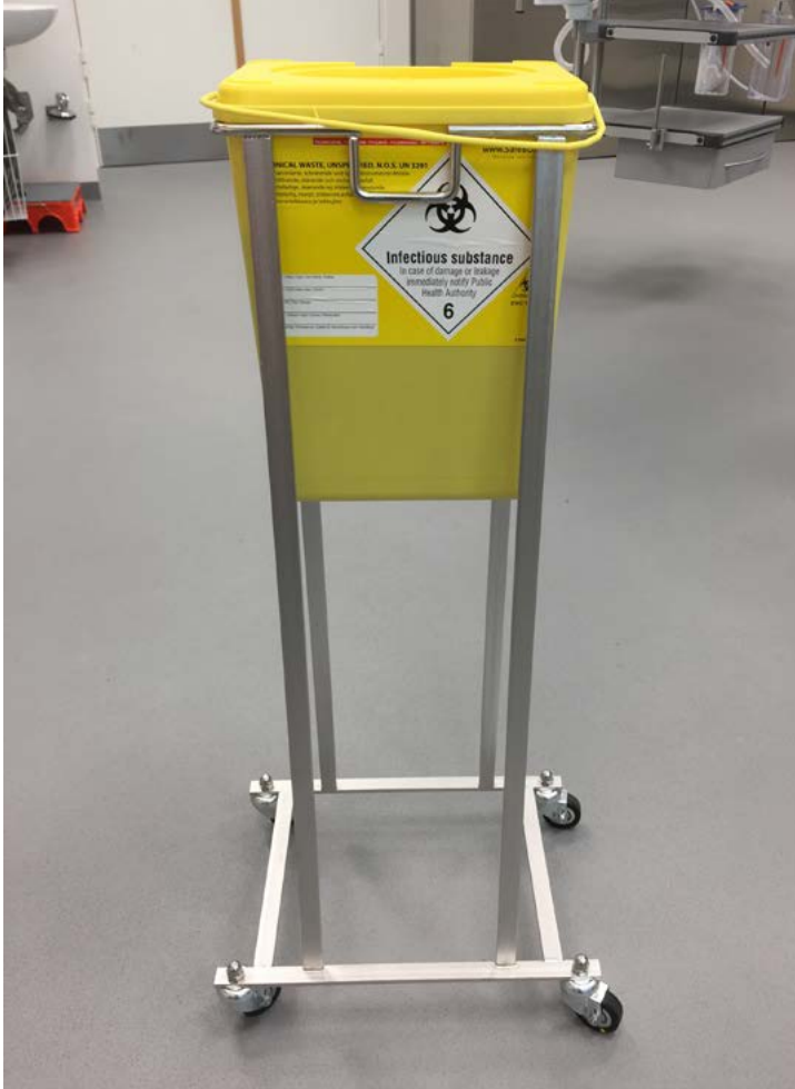
Billede 4.2.5 – På billedet ses en nåleboks i et stativ på hjul. Denne løsning er udviklet af afdeling R og fabrikeret af BDS.
